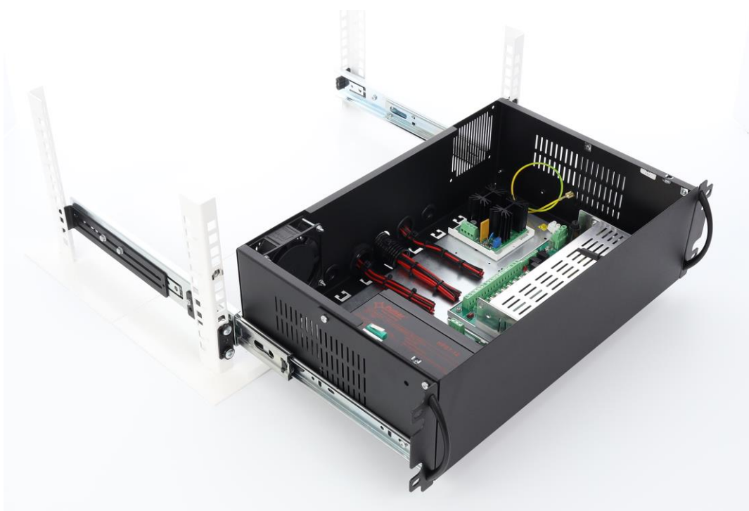
Wsuń obudowę z prowadnicami w szyny zamontowane w szafie RACK 19"
